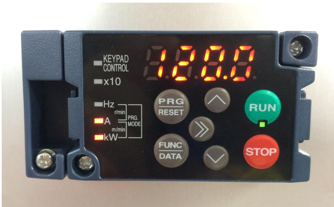
1. Die Geschwindigkeitseinstellungen des Sägeblatts erfolgen über das in Abb. 1 dargestellte Bedienfeld.
