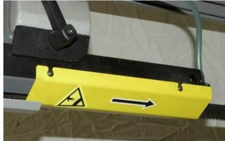
Nach dem Anschluss schalten Sie die Bandsäge kurz ein, und kontrollieren Sie, ob die Drehrichtung des Sägebandes mit dem Pfeil übereinstimmt. Stimmt die Drehrichtung des Sägebandes nicht, tauschen Sie 2 Phasen an den Klemmen.
