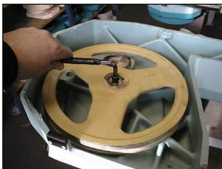
2. Schrauben Sie die Befestigungsschraube des Antriebsrades heraus und entnehmen Sie die Scheibe vom Antriebsrad.
