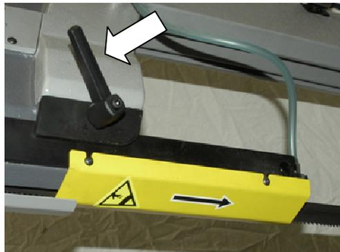
1. Lösen Sie den Klemmhebel der linken Bandführungsleiste und schieben Sie die Bandführungsleiste so nahe als möglich zum geschnittenen Material.
