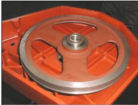
10. Legen Sie das zweite Lager auf die Welle und drücken Sie es bis zum Distanzring.
