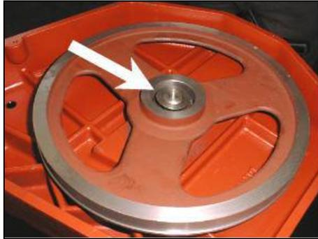
9. Setzen Sie den Distanzring auf die Welle und schieben Sie diesen bis zum unteren Lager.
