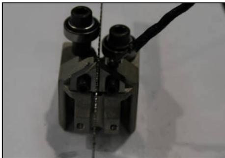
6. Justieren Sie auch die Karbid-Führungen so, dass sich das Sägeband zwischen ihnen mit dem notwendigen Spiel frei bewegen kann. Ziehen Sie die vorderen Schrauben der HM-Führungen an, anschließend ziehen Sie die Gewindestifte fest.
