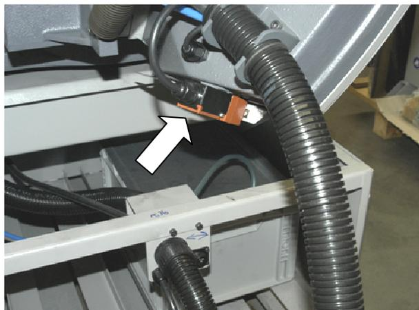
Die Maschine kann erst wieder in Betrieb gesetzt werden, wenn die Sägebandschutzabdeckung geschlossen ist!
