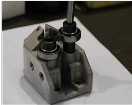
2. Spannen Sie den Führungsblock in einen Schraubstock ein und entfernen Sie beide Befestigungsschrauben der Exzenter.
