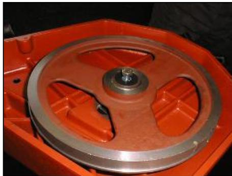
2. Schrauben Sie die Befestigungsschraube des Umlenkrades heraus und entfernen Sie die Scheibe vom Umlenkrad.
