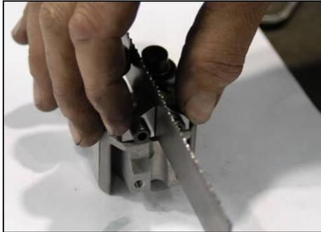
5. Legen Sie ein Probestück des Sägebands (etwa 15–20 cm) in den Führungsblock und stellen Sie die Exzenter so ein, daß das Sägeband in der Mitte der Führung verläuft. Die Führung befindet sich zwischen den Befestigungen der Exzenter. Die Führungsrollen dürfen nicht fest auf das Sägeband drücken, sondern müssen sich leicht drehen lassen.
