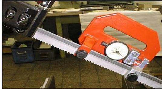
2. Setzen Sie das Messgerät auf das Sägeband und sichern Sie es mit den Schrauben.
