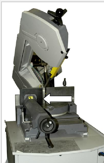
5. Schieben Sie den Spannstock laut des eingestellten Schnittwinkels; für Schnittwinkel kleiner als  $0^\circ$  nach **rechts**, für Schnittwinkel grösser als  $0^\circ$  nach **links**
