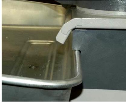
1. Setzen Sie die Wanne auf das Untergestell an der hinteren Seite der Säge auf.
