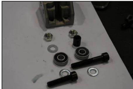
3. Wechseln Sie beide Führungsrollen aus den Exzenter aus.
