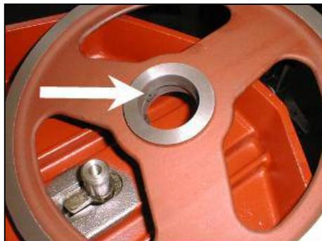
6. Legen Sie den Sicherungsring in das Loch vom Umlenkrad ein.
