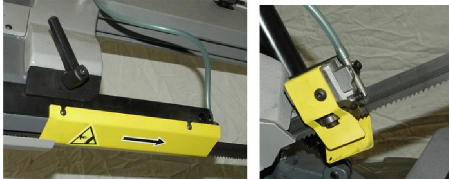
2. Demontieren Sie nun die gelben Schutzbleche des Sägebandes. Die Schutzbleche sind mit zwei Schrauben befestigt.
