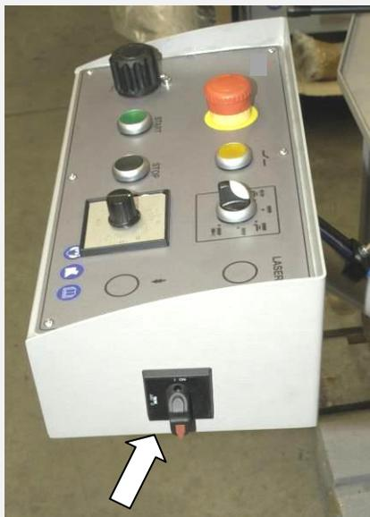
2. Schalten Sie den Sicherheitskreis der Säge ein. Der Sicherheitskreis wird alle Sicherheitsschalter der Säge kontrollieren.
