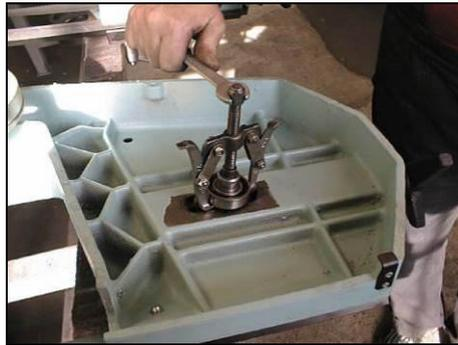
5. Sollte das untere Lager des Umlenkrades auf der Welle bleiben, so ziehen Sie dieses mit einem Abzieher von der Welle ab. Kontrollieren Sie den Zustand beider Lager, bzw. tauschen Sie sie.
