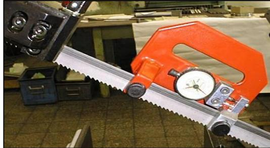
2. Setzen Sie das Bandsägemessgerät auf das Sägeband und sichern Sie es mit den Schrauben.
