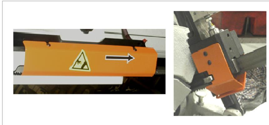
2. Demontieren Sie nun die Schutzbleche des Sägebandes. Die Schutzbleche sind mit zwei Schrauben befestigt.
