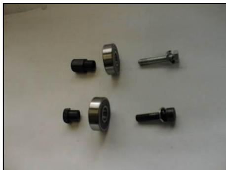
3. Ziehen Sie nun beide Führungsrollen von den Exzentern ab.
