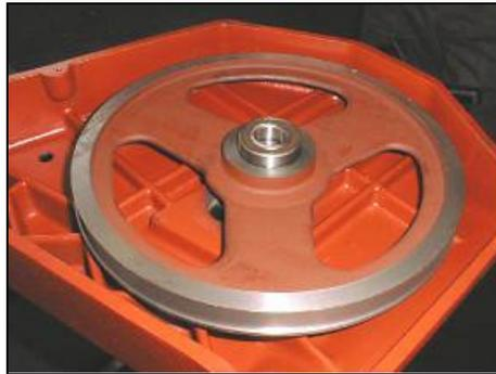
10. Legen Sie das zweite Lager auf die Welle ein und drücken Sie es bis zum Distanzring.
