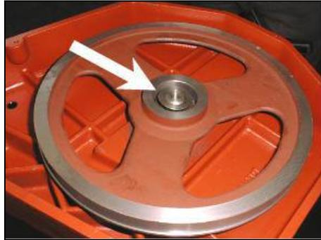
9. Setzen Sie den Distanzring auf die Welle und schieben Sie ihn bis zum unteren Lager.
