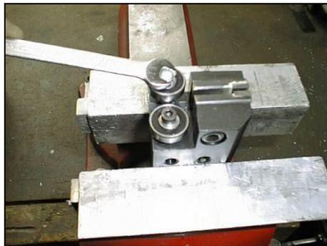
2. Spannen Sie den Führungsklotz in einen Schraubstock. Demontieren Sie nun beide Befestigungsschrauben der Exzenter.
