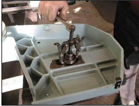
5. Sollte das untere Lager des Umlenkrades auf der Welle bleiben, so ziehen Sie dieses mit einem Abzieher von der Welle ab. Kontrollieren Sie den Zustand beider Lager, bzw. tauschen Sie sie.
