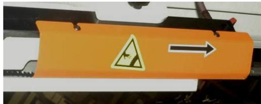
Nach dem Anschluss schalten Sie die Bandsäge kurz ein, und kontrollieren Sie, ob die Drehrichtung des Sägebandes mit dem Pfeil stimmt. Stimmt die Drehrichtung des Sägebandes nicht, tauschen Sie 2 Phasen an den Klemmen aus.
