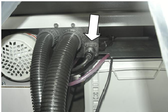
4. Stellen Sie den Zuleitungskabel der Pumpe von der Steckverbindung ab.
