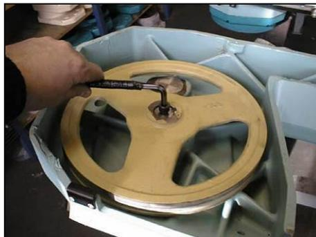
2. Schrauben Sie die Befestigungsschraube des Antriebrades heraus und entnehmen Sie die Scheibe des Antriebrades.
