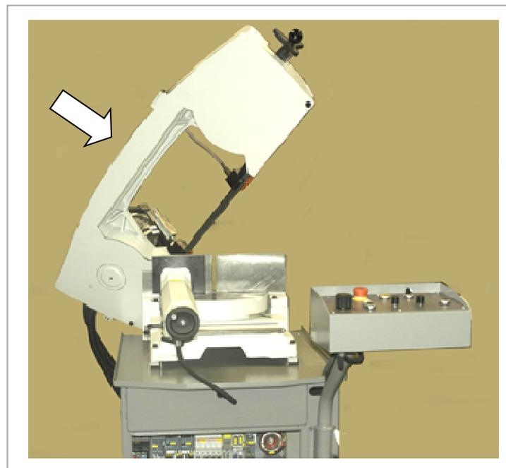
Die Maschine wird sofort stillgesetzt, sobald die Sägebandschutzabdeckung geöffnet wird.
