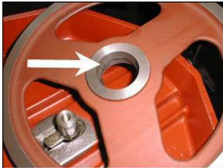
6. Legen Sie den Sicherungsring in das Loch in dem Umlenkrad ein.
