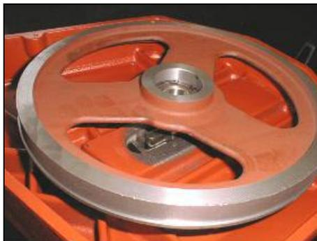
8. Säubern Sie nun die Welle und fetten Sie diese ein. Setzen Sie das neue Umlenkrad vorsichtig auf die Welle.
