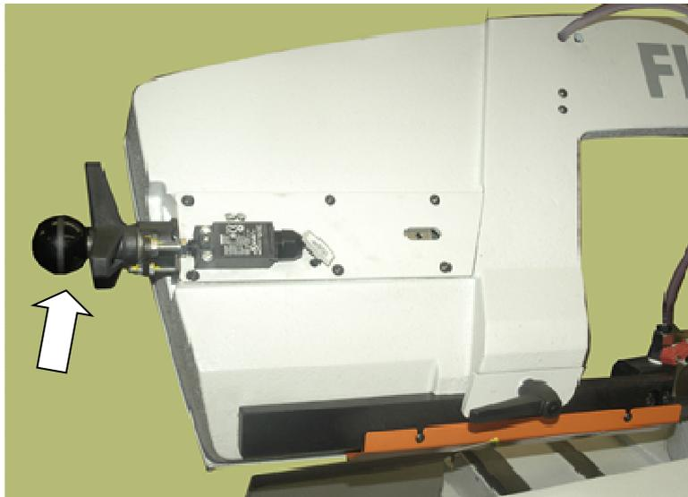
5. Lösen Sie die Bandspannung am Sterngriff, indem Sie diesen nach links drehen.
