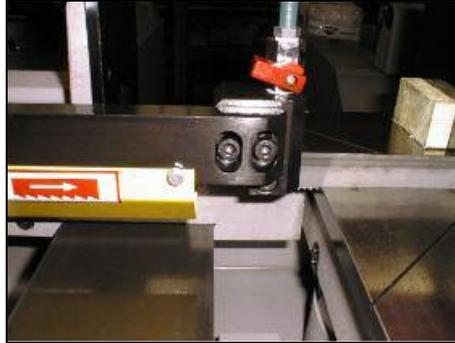
1. Demontieren Sie das Sägeband. Ziehen Sie den Kühlmittelschlauch vom Anschluss und demontieren Sie den Bandführungsklotz.
