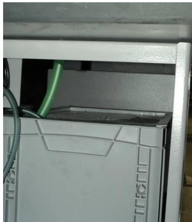
2. Setzen Sie den Schlauch für Ableitung der Flüssigkeit auf den Ablass der Wanne auf und tauchen Sie das andere Ende ins Kühlungsflüssigkeitsgefäß ein.
