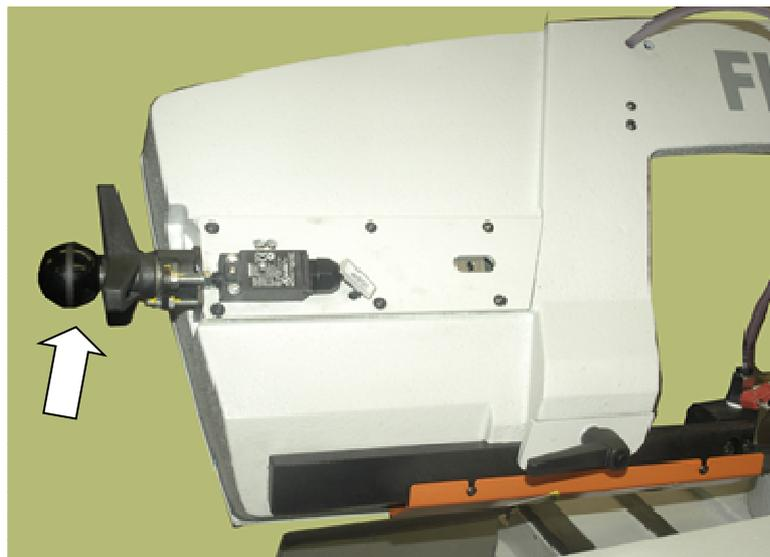
4. Spannen Sie das Sägeband jetzt leicht an, indem Sie den Spannster nach rechts drehen. Entfernen Sie jetzt den Kantenschutz des Sägebandes.
