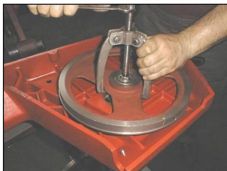
4. Setzen Sie einen Abzieher auf das Umlenkrad und ziehen Sie dieses vorsichtig von der Welle ab.
