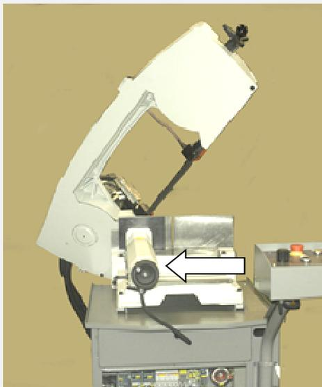
5. Schieben Sie den Spannstock laut des eingestellten Schnittwinkels; für Schnittwinkel kleiner als  $0^\circ$  nach **rechts**, für Schnittwinkel grösser als  $0^\circ$  nach **links**
