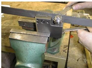
9. Legen Sie nun ein Reststück eines Sägebandes (ca. 15-20cm) in den Führungsklotz ein. Stellen Sie die Exzenter so ein, dass das Sägeband in der Mitte läuft. Weiter dürfen die Führungsrollen nicht zu fest am Sägeband anliegen, sondern müssen sich leicht drehen.
