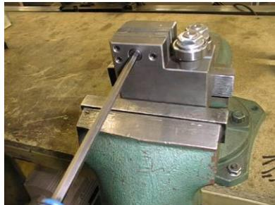
3. Lösen Sie die Befestigungsschraube der Hartmetallführung und entfernen Sie die Hartmetallführung
