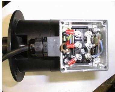
3. Demontieren Sie die Abdeckung der Anschlussbox. Öffnen Sie die vier Klemmen der Eingangskabel. Die Eingangskabel sind an den roten Kabelklemmen zu erkennen.
