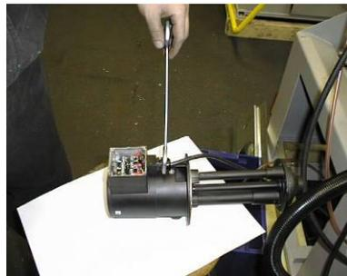
4. Lösen Sie nun die Eingangsverschraubung und ziehen Sie das Kabel aus der Kühlmittelpumpe.
