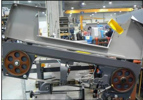
Die Maschine kann erst wieder in Betrieb gesetzt werden, wenn die Sägebandschutzabdeckung geschlossen ist.
