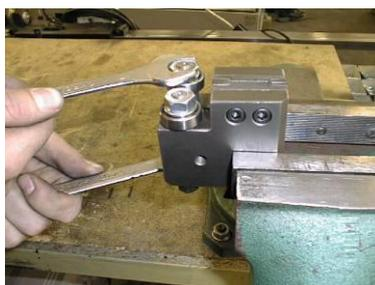
8. Schrauben Sie die Sicherungsmuttern auf Exzenter.
