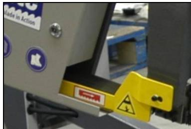
2. Demontieren Sie nun das Schutzblech des Sägebandes. Das Schutzblech ist mit zwei Schrauben befestigt.
