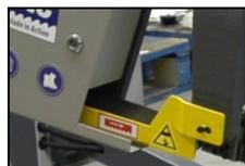
Nach dem Anschluss schalten Sie die Bandsäge kurz ein, und kontrollieren Sie, ob die Drehrichtung des Sägebandes mit dem Pfeil stimmt. Stimmt die Drehrichtung des Sägebandes nicht, tauschen Sie 2 Phasen an den Klemmen aus.
