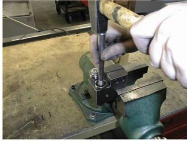
5. Schlagen Sie die Exzenter mit Hilfe von Anschlag aus den Lagern.
