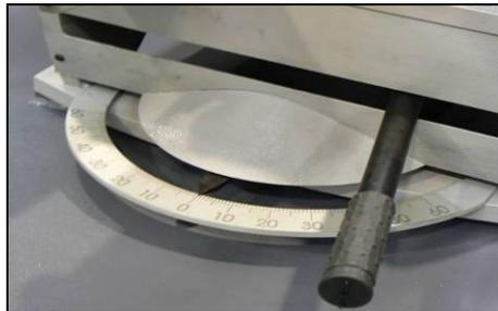
1. Lösen Sie den Hebel, stellen Sie einen gewünschten Schnittwinkel ein und ziehen Sie den Hebel wieder fest.
