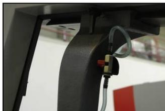
1. Lösen Sie den Klemmhebel der linken Bandführungsleiste und schieben Sie die Bandführungsleiste so nahe als möglich zum geschnittenen Material.
