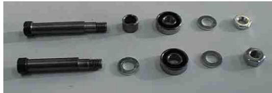
6. Tauschen Sie beide abgenutzte Lager, bzw. auch andere abgenutzte Teile, aus.
