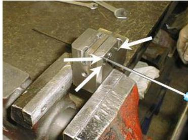
2. Lösen Sie die Einstellschrauben der Hartmetallführung.
