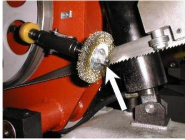
1. Lösen Sie die Mutter an der Spänebürste, ziehen Sie die Spänebürste herunter, setzen Sie die neue Spänebürste an, und ziehen Sie die Mutter wieder fest.
