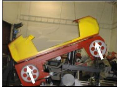
3. Legen Sie nun das Sägeband auf beide Laufräder auf. Achten Sie darauf, dass der Sägebandrücken am Laufkranz der Räder anliegen muss, d.h. wenn Sie das Sägeband aufgelegt haben, schieben Sie es so weit als möglich nach hinten.
