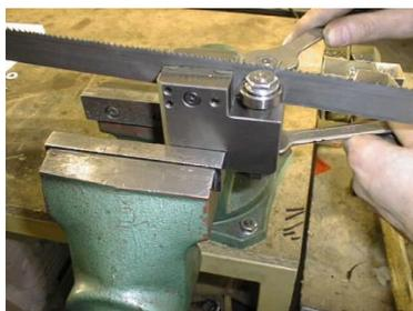
12. Legen Sie nun ein Reststück eines Sägebandes (ca. 15-20cm) in den Führungsklotz ein. Stellen Sie die Exzenter so ein, dass das Sägeband in der Mitte läuft. Weiter dürfen die Führungsrollen nicht zu fest am Sägeband anliegen, sondern müssen sich leicht drehen.
