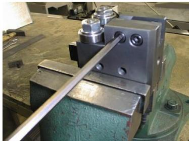
4. Lösen Sie die Befestigungsschraube der zweiten Hartmetallführung und entfernen Sie die Hartmetallführung
