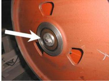
15. Schrauben Sie die Schraube heraus und entfernen Sie die Scheibe.
