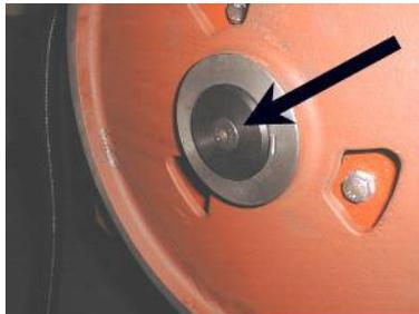
5. Schrauben Sie die Schraube heraus und entfernen Sie die Scheibe.
