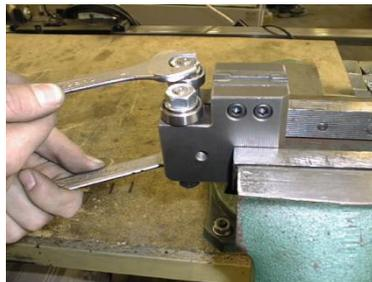
6. Spannen Sie den Führungsklotz in einen Schraubstock. Demontieren Sie nun beide Befestigungsschrauben der Exzenter.
