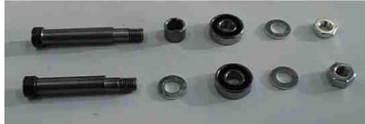
9. Tauschen Sie beide abgenutzte Lager, bzw. auch andere abgenutzte Teile, aus.
