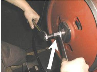
8. In das Loch in der Welle schrauben Sie den Aufzieher. Durch Festziehen der Mutter schieben Sie das Antriebsrad auf die Welle.
