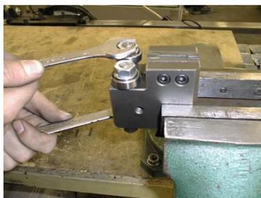
11. Schrauben Sie die Sicherungsmuttern auf Exzenter.
