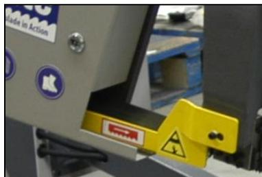
6. Montieren Sie jetzt das Schutzblech an der Bandführungsleiste.
