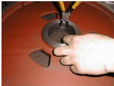
20. Legen Sie den Sicherungsring in das Loch an dem Rad ein.
