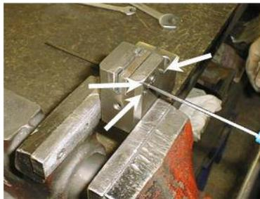
2. Lösen Sie die Einstellschrauben der Hartmetallführung.
