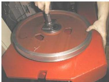
22. Setzen Sie das Umlenkrad auf die Welle. In das Loch in der Welle schrauben Sie den Aufzieher.
