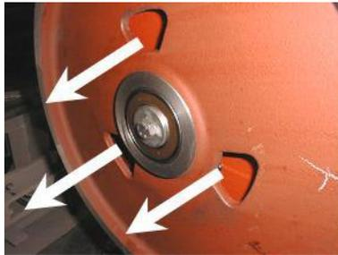
16. Setzen Sie einen Abzieher auf das Umlenkrad und ziehen Sie dieses vorsichtig von der Welle ab. Sollte das untere Lager des Umlenkrades auf der Welle bleiben, so ziehen Sie dieses mit einem Abzieher von der Welle ab.
