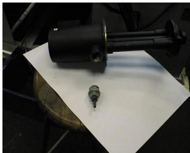
6. Schrauben Sie die Eingangsverschraubung fest und montieren Sie die Abdeckung der Anschlussbox. Achten Sie hierbei auf die Dichtung! Dichten Sie nun den Anschluss des Kühlmittelschlauches mit Teflonband ab und schrauben Sie ihn wieder ein. Stecken Sie den Kühlmittelschlauch auf. Setzen Sie die Kühlmittelpumpe wieder auf das Halteblech und verschrauben Sie die Pumpe wieder.
