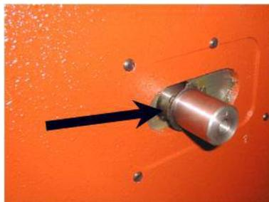
18. Säubern Sie die Welle und fetten Sie die ein. Setzen Sie den Sicherungsring auf die Welle.
