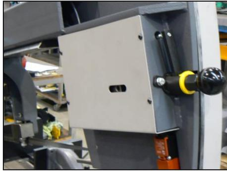
Der Sägebandlauf wird mit der Einstellschraube eingestellt.
