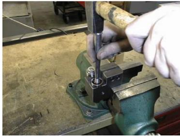
8. Schlagen Sie die Exzenter mit Hilfe von Anschlag aus den Lagern.
