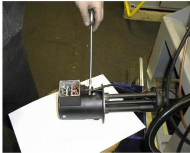
4. Lösen Sie nun die Eingangsverschraubung und ziehen Sie das Kabel aus der Kühlmittelpumpe.
