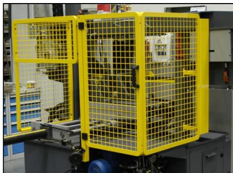
Die Tür der Schutzumzäunung ist mit einem Endschalter geschützt. Bei der Öffnung des Endschalters wird die Maschine abgestellt.
