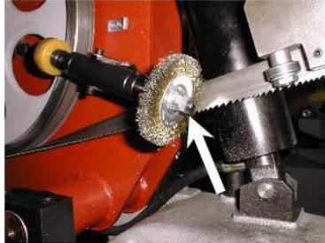
1. Lösen Sie die Mutter an der Spänbürste, ziehen Sie die Spänbürste herunter, setzen Sie die neue Spänbürste an, und ziehen Sie die Mutter wieder fest.
