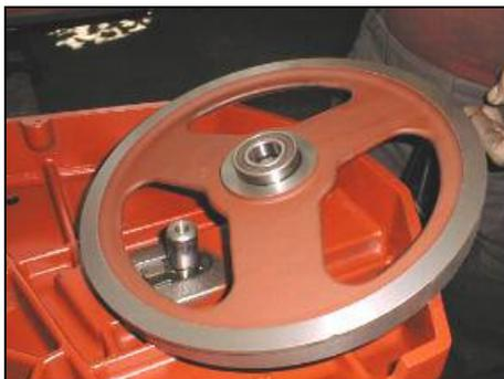
7. Legen Sie das Lager in das Loch in dem Umlenkrad ein, und drücken Sie es bis zum Sicherungsring.
