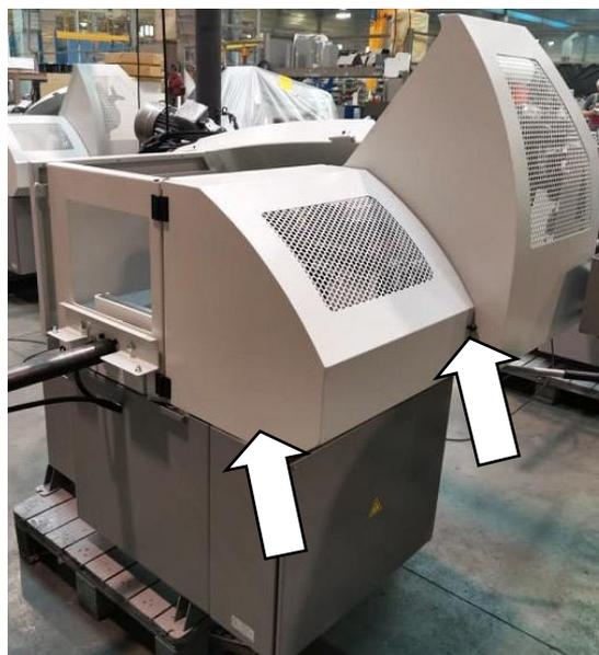
Wird das Gehäuse während des Betriebs geöffnet, öffnet sich der Endschalter (s. Pfeil); die Maschine wird sofort gestoppt und darf nicht einmal in der Einstellbetriebsart verwendet werden.
