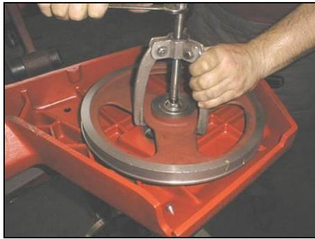
4. Setzen Sie einen 3-Arm-Abzieher auf das Umlenkrad und ziehen Sie dieses vorsichtig von der Welle ab.
