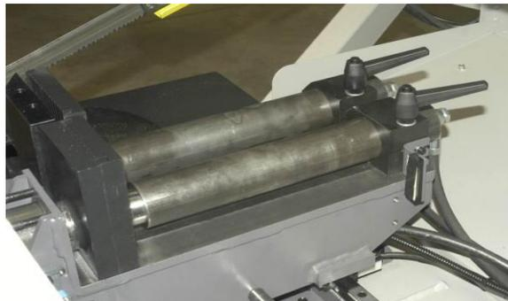
1. Den Sicherungsbolzen des Arretierhebels betätigen und durch Drehen des Arretierhebels den Vorschub der Backe lösen.
