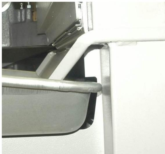
1. Die Auffangwanne für Kühlmittel an die Seitenwand der Säge, auf den Sockel einsetzen.
