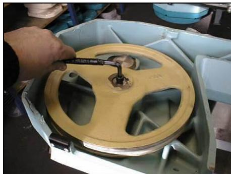
2. Schrauben Sie die Befestigungsschraube des Antriebsrades heraus und entnehmen Sie die Scheibe vom Antriebsrad.
