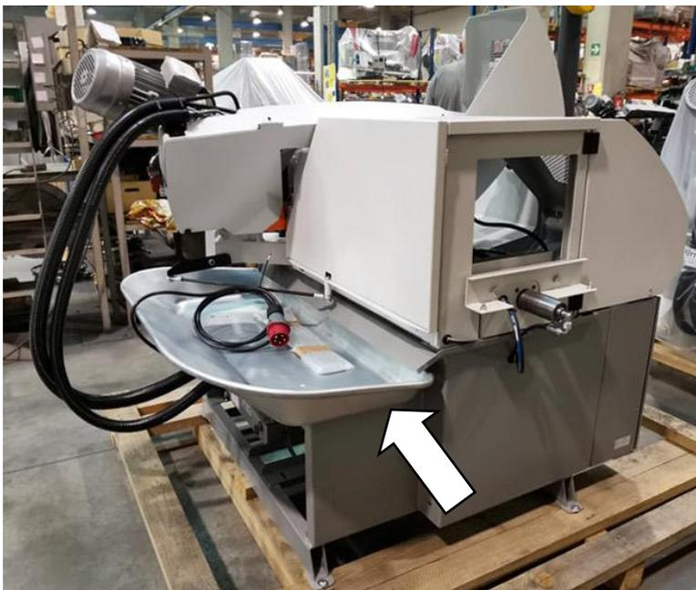
Wird kein Kühlmittelbehälter verwendet, besteht Gefahr der Kühlmittelentweichung ins Umfeld der Maschine und Gefahr der Kühlmitteldurchdringung in die elektrischen Anlagen der Maschine.
