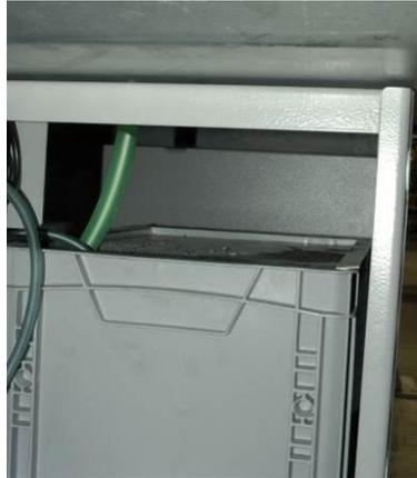
2. Setzen Sie den Schlauch für Ableitung der Flüssigkeit auf den Ablass der Wanne auf und tauchen Sie das andere Ende ins Kühlungsflüssigkeitgefäß ein.
