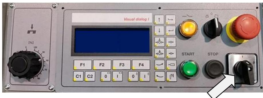
Bei der Maschine, die mit einem zweistufigen Geschwindigkeitsumschalter ausgestattet ist, wird die geforderte Schnittgeschwindigkeit mit Drehen des Umschalters (auf dem Bedienfeld) eingestellt.
