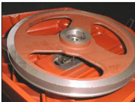
8. Säubern Sie nun die Welle und fetten Sie diese ein. Setzen Sie das neue Umlenkrad vorsichtig auf die Welle.
