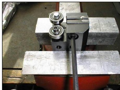
2. Spannen Sie den Führungsklotz in einen Schraubstock. Lösen Sie nun die Befestigungsschrauben beider Hartmetallführungen und entfernen Sie diese.
