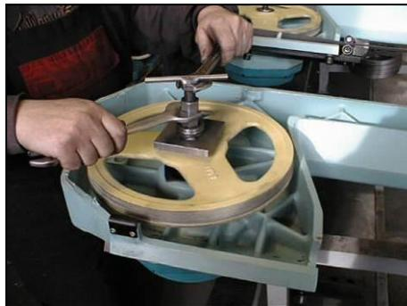
6. Ist die Antriebswelle und die Passfeder in Ordnung, so fetten Sie beide ein. Setzen Sie das Antriebsrad auf und ziehen Sie es fest.
