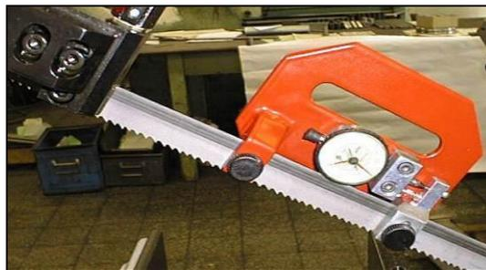
2. Setzen Sie das Tenzomat auf das Sägeband und sichern Sie es mit den Schrauben.
