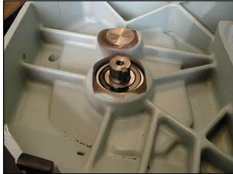
5. Kontrollieren Sie, ob die Passfeder und die Antriebswelle nicht beschädigt sind. Sollten diese beschädigt sein, muss die Antriebswelle unbedingt ausgetauscht werden. Für Austausch der beschädigten Teile kontaktieren Sie ihren Lieferant.
