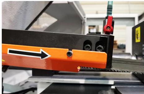
1. Demontieren Sie das Sägeband. Ziehen Sie den Kühlmittelschlauch vom Anschluss und demontieren Sie den Bandführungsklotz.
