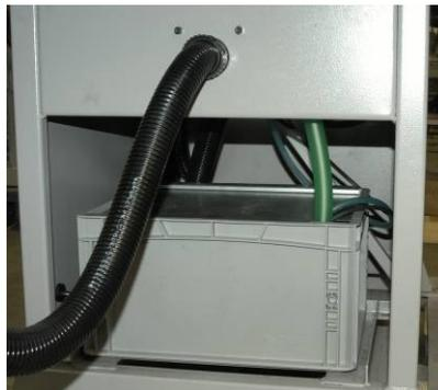
2. Setzen Sie den Schlauch für Ableitung der Flüssigkeit auf den Ablass der Wanne auf und tauchen Sie das andere Ende ins Kühlflüssigkeitsgefäß ein.
