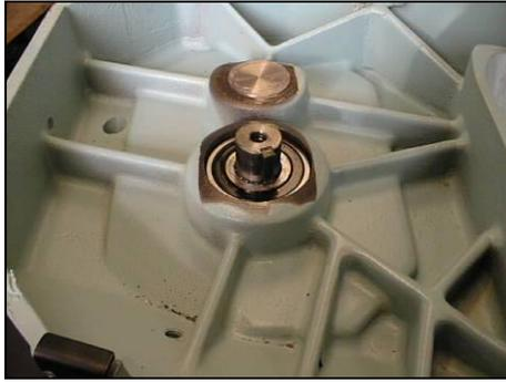
5. Kontrollieren Sie, ob Passfeder und Antriebswelle nicht beschädigt sind. Sollten diese beschädigt sein, muss die Antriebswelle unbedingt ausgetauscht werden. Für Austausch der beschädigten Teile kontaktieren Sie ihren Lieferanten.
