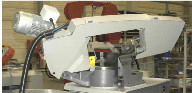
Die Maschine kann erst wieder in Betrieb gesetzt werden (sogar im Servicemodus), wenn die Sägebandschutzabdeckung geschlossen ist!
