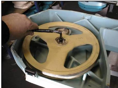
2. Schrauben Sie die Befestigungsschraube des Antriebsrades heraus und entnehmen Sie die Scheibe des Antriebsrades.
