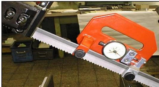
2. Setzen Sie das Sägebandmessgerät auf das Sägeband und sichern Sie es mit den Schrauben.
