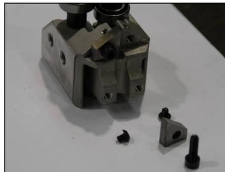
4. Schrauben Sie die vorderen Schrauben ab, die die HM-Führungen halten.
