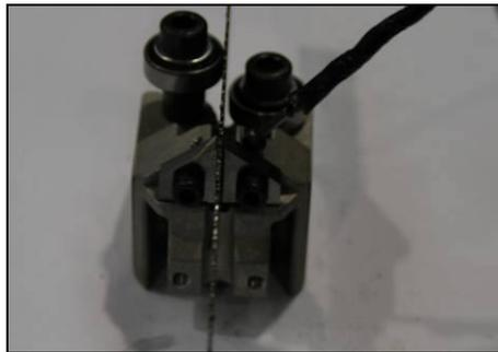
6. Justieren Sie auch die Karbid-Führungen so, daß sich das Sägeband zwischen ihnen mit dem notwendigen Spiel frei bewegen kann. Ziehen Sie die vorderen Schrauben der HM-Führungen an, anschließend ziehen Sie die Gewindestifte fest.
