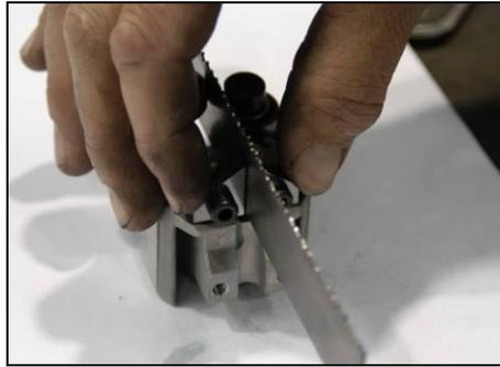
5. Legen Sie ein Probestück des Sägebands (etwa 15–20 cm) in den Führungsblock und stellen Sie die Exzenter so ein, daß das Band in der Mitte der Rille verläuft. Die Rille befindet sich zwischen den Befestigungen der Exzenter. Die Führungsrollen dürfen nicht fest auf das Sägeband drücken, sondern müssen sich leicht drehen lassen.
