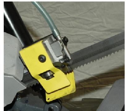
7. Montieren Sie jetzt die Schutzbleche an der Bandführungsleiste.
