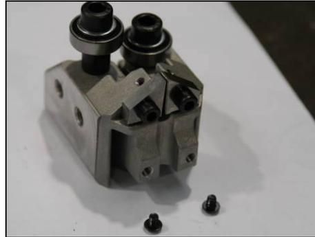
3. Lösen Sie die Gewindestifte mit einem Inbus-Schlüssel.
