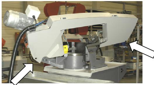
6. Montieren Sie die Sägebandschutzabdeckung mit 2 Plastikschrauben.
