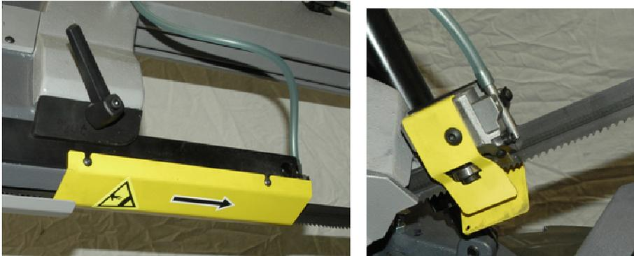
2. Demontieren Sie nun die gelben Schutzbleche des Sägebandes.
