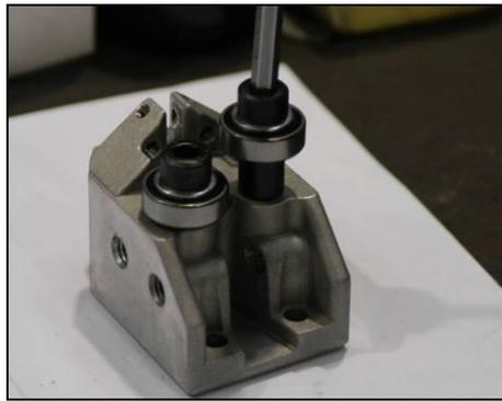
2. Spannen Sie den Führungsblock in einen Schraubstock ein und entfernen Sie beide Befestigungsschrauben der Exzenter.
