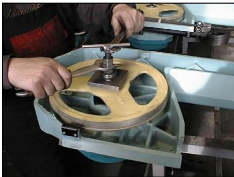
6. Sind Antriebswelle und Passfeder in Ordnung, so fetten Sie beide ein. Setzen Sie das Antriebsrad auf und ziehen Sie es fest.
