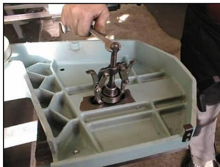
5. Sollte das untere Lager des Umlenkrades auf der Welle bleiben, so ziehen Sie dieses mit einem 2-Arm-Abzieher von der Welle ab. Kontrollieren Sie den Zustand beider Lager, bzw. tauschen Sie sie.
