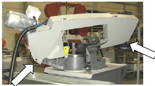
3. Öffnen Sie nun die Sägebandschutzabdeckung. Die Sägebandschutzabdeckung ist mit zwei Schrauben mit Kunststoffgriff befestigt.
