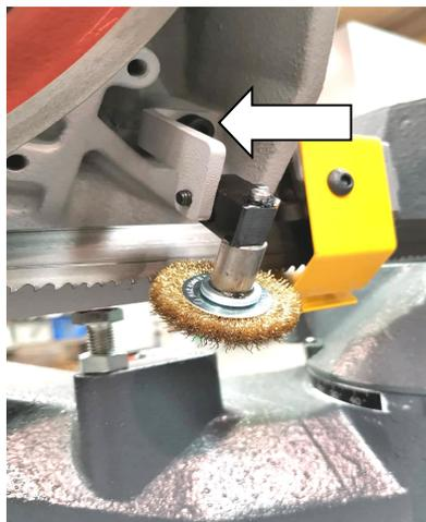
2. Lockern Sie die Halterung der Spanbürste und drehen Sie diese vom Sägeband weg.
