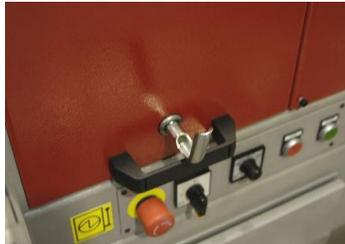
3. Lösen Sie die Mutter (Achtung-Linksgewinde) auf der Bürste.
