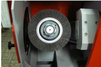
4. Schrauben Sie mit einem Schlüssel die Mutter ab.
