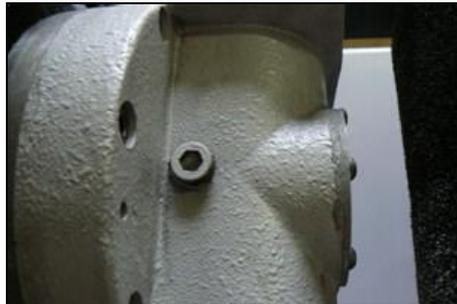
Alle vier Monate das Getriebeöl mit Hilfe des Ablaßstopfenes ablassen und mit dem universal Getriebeöl, Menge- 300 ml auffüllen und wieder verschließen.
