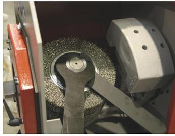
3. Stellen Sie sicher, dass der Mindestabstand von dem Bürstenkopf der Maschine 5 mm sind.
