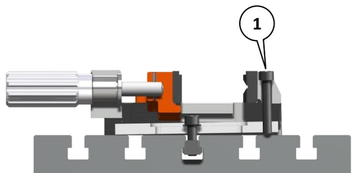
Schraube **1** anziehen, um Klemmschiene **3** zu spannen → Spanner geklemmt.
