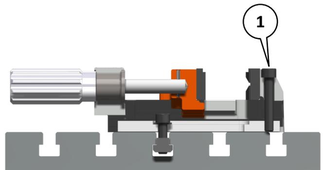
Schraube **1** komplett lösen, damit das Klemmblech **3** auf dem Tisch aufliegt. Schraube **2** festziehen und dann wieder leicht lösen, so dass der Spanner gerade noch über den gesamten Bereich verschoben werden kann.
