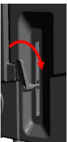
7. Ziehen Sie den Hebel des Festanschlags in dieser Stellung handfest an. Der Festanschlag begrenzt nun die Bohrtiefe für die nächsten Bohrungen.
