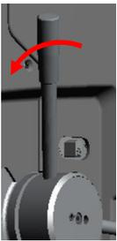
5. Führen Sie den Bohrer mit Hilfe des Bohrkreuzes nun langsam in Richtung Werkstück, in dem Sie das Bohrkreuz nach unten drücken. Bohren Sie das erste Sackloch in das Werkstück. Halten Sie das Bohrkreuz in der untersten Stellung des Bohrlochs.
