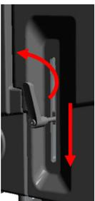
6. Lösen Sie den Hebel des Festanschlags und schieben den Festanschlag bis zur untersten Stellung.
