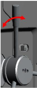
5. Führen Sie den Bohrer mit Hilfe des Bohrkreuzes nun langsam in Richtung Werkstück, in dem Sie das Bohrkreuz nach unten drücken. Bohren Sie das Durchgangsloch in das Werkstück.
