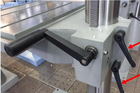
1. Lösen Sie den/die Spannhebel des Bohrtisches auf der Rückseite der Maschine.
