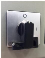
1. Drehen Sie den Hauptschalter Ein/Aus auf die Stellung **0**, um die Maschine komplett auszuschalten.
