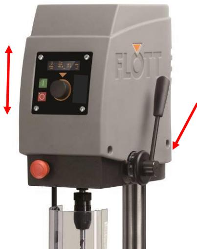
1. Lösen Sie den Spannhebel des Maschinenkopfs auf der Rückseite der Maschine.
