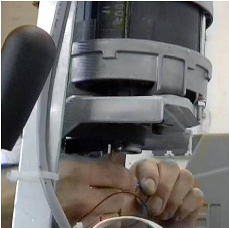
4. Lösen Sie auf der Unterseite der Motorhalterung jeweils zwei Innensechskantschrauben der Größen 4 und 5, um den Motor samt hinterer Riemenscheibe zu lösen. Dadurch wird die Spannung des Keilrippenriemens gelöst.
