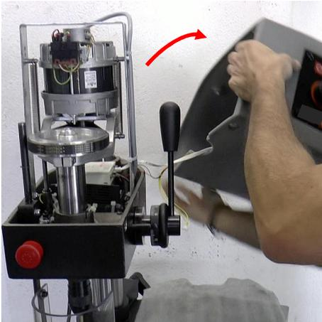
6. Schwenken Sie die Schutzhaube mit dem angeschlossenen Kabel nach rechts hinter dem Bohrhebel herum.
