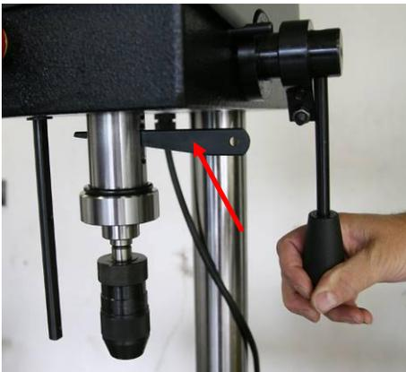
4. Drehen Sie (2. Person) den Bohrhebel so weit nach unten, bis die seitlichen Austreiböffnungen sichtbar werden. Halten Sie den Bohrhebel in dieser Stellung fest.
