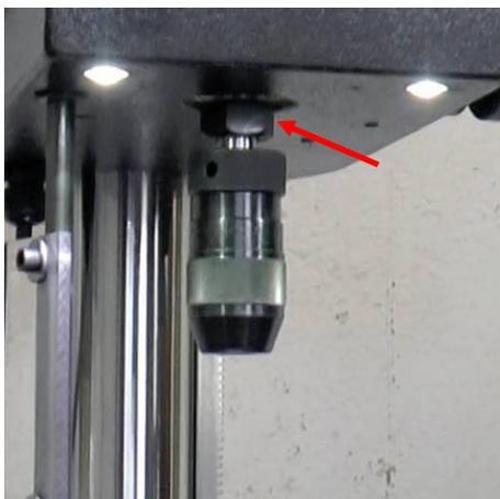
3. Entnehmen Sie zunächst das Werkzeug aus dem Bohrfutter, bevor Sie das Bohrfutter demontieren.
