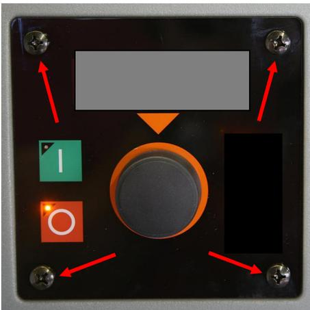
2. Lösen Sie die 4 Kreuzschlitzschrauben des Bedienpults und entfernen Sie diese.
