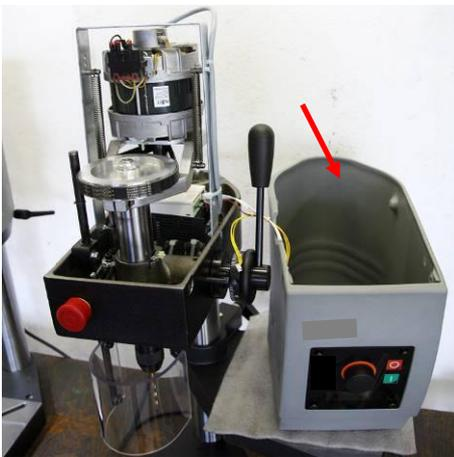
1. Entfernen Sie die Schutzhaube vom Maschinenkopf (siehe Kapitel 9.3 *Schutzhaube (de)montieren*). Anschließend ist der komplette Antriebsbereich inkl. Frequenzumrichter zugänglich.
