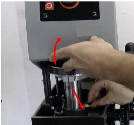
1. Warten Sie mindestens 15 min., bevor Sie die Schutzhaube entfernen. Erst danach sind die Kondensatoren unter der Schutzhaube entladen.
