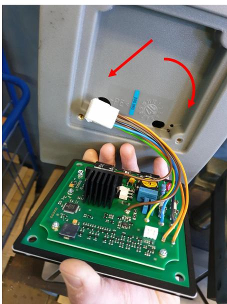
5. Klappen Sie das Bedienpult ein kleines Stück aus dem Einsatz der Schutzhaube nach unten und halten es mit einer Hand fest.
