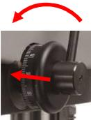
7. Schieben Sie den Festanschlag bis zum Anschlag auf die Bohrhebelachse.
