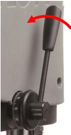
6. Führen Sie den Bohrer mit Hilfe des Bohrhebels nun langsam in Richtung Werkstück, in dem Sie den Bohrhebel nach unten drücken. Bohren Sie das erste Durchgangs- oder Sackloch in das Werkstück. Halten Sie den Bohrhebel in der untersten Stellung des Bohrlochs.
