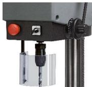
4. Entriegeln Sie den NOT-AUS-Taster, in dem Sie diesen gegen den Uhrzeigersinn drehen und schalten Sie die Maschine über den Hauptschalter ein.
