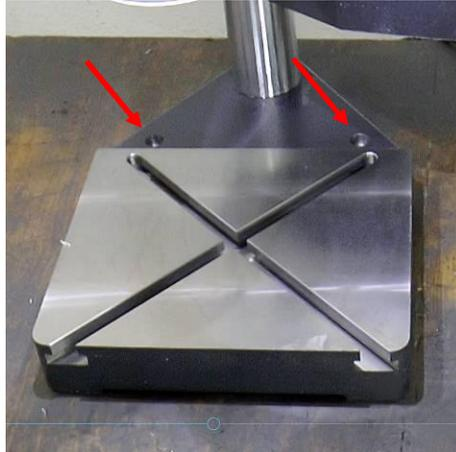
6. Versetzen Sie die Maschine ein Stück und führen die Bohrungen aus (je nach Ausführung mit 2 oder 4 Durchgangs- oder Dübellöchern für M10).
