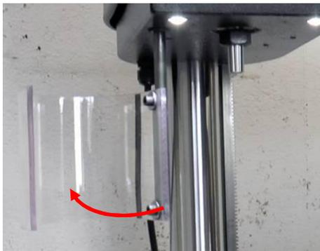
1. Schwenken Sie den Bohrschutz von Hand zur linken Seite. Dadurch wird der Bohrschutzschalter betätigt und ein Starten der Maschine verhindert.
