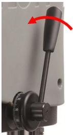
6. Führen Sie den Bohrer mit Hilfe des Bohrhebels nun langsam in Richtung Werkstück, in dem Sie den Bohrhebel nach unten drücken. Bohren Sie das erste Durchgangs- oder Sackloch in das Werkstück. Halten Sie den Bohrhebel in der untersten Stellung des Bohrlochs.
