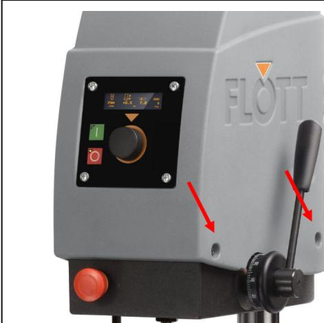
10. Stecken Sie den Stecker auf den freien Anschluss neben der Pinole. Achten Sie darauf, dass der Stecker korrekt einrastet und das Kabel nicht zwischen Schutzhaube und Maschinenkopf eingeklemmt wird.
