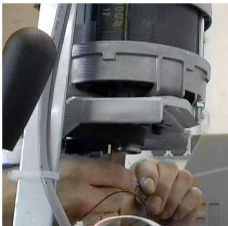
4. Lösen Sie auf der Unterseite der Motorhalterung jeweils zwei Innensechskantschrauben der Größen 4 und 5, um den Motor samt hinterer Riemenscheibe zu lösen.
