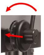
7. Schieben Sie den Festanschlag bis zum Anschlag auf die Bohrhebelachse.
