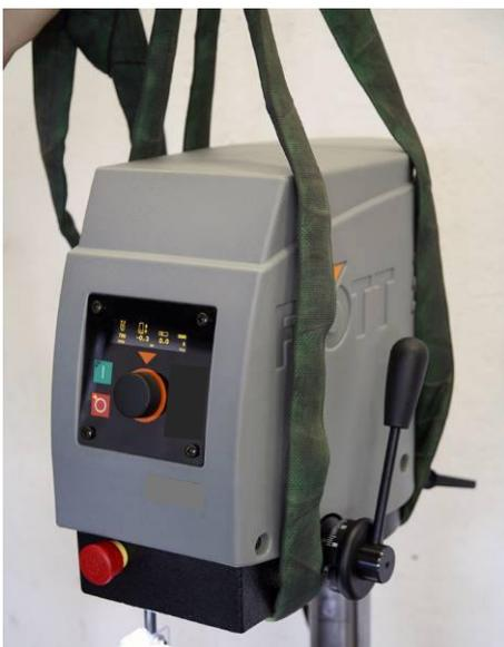
1. Setzen Sie die Tragegurte, wie in der Abbildung dargestellt, ein. Dabei müssen die Tragegurte jeweils vor und hinter der Spindel um den Maschinenkopf gelegt sein.
