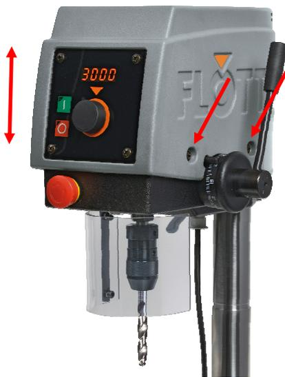
1. Lösen Sie den Spannhebel des Maschinenkopfs auf der Rückseite der Maschine.
