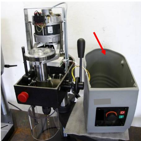
1. Entfernen Sie die Schutzhaube vom Maschinenkopf (siehe Kapitel 9.3 *Schutzhaube (de)montieren*, Seite 53). Anschließend ist der komplette Antriebsbereich inkl. Frequenzumrichter zugänglich.
