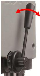
7. Führen Sie den Bohrer mit Hilfe des Bohrhebels nun langsam in Richtung Werkstück, in dem Sie den Bohrhebel nach unten drücken. Bohren Sie das Durchgangsloch in das Werkstück.
