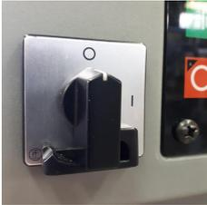
3. Drehen Sie den Hauptschalter in Richtung I, um die Spannungsversorgung der Maschine einzuschalten.
