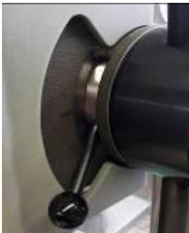
Greifen Sie den Umschalthebel am Knauf und bewegen ihn nach unten bis zum unteren Anschlag. Die Position des Hebels wird durch die Steuerung ausgewertet. Wenn der Hebel nicht vollständig bis nach unten bewegt wird, schaltet die Maschine nicht in den Automatikbetrieb um.
