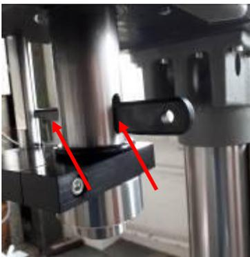
4. Drehen Sie den Bohrhebel soweit nach unten, bis die seitlichen Austreiböffnungen sichtbar werden. Halten Sie den Bohrhebel in dieser Stellung fest.
