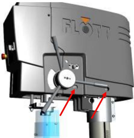
3. Setzen Sie auf beiden Seiten der hinteren Schutzhaube je 2 Schrauben ein und ziehen diese handfest an.
