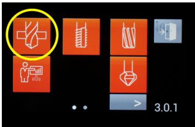
3. Die Einstellungen für Bohren und Gewindebohren in der Stufenprogrammierung werden sinngemäß wie beim „Automatischen Bohren“ und „Automatischen Gewinden“ (Kap. 6.4.5 und Kap. 6.4.6) vorgenommen.
