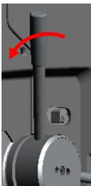
8. Lösen Sie den Hebel des Festanschlags und schieben den Festanschlag bis zur untersten Stellung.
