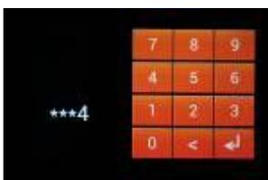
Für den Fall, dass der Automatikbetrieb gesperrt ist, geben Sie die Maschine frei, indem Sie den Auto-Sperrcode eingeben (bei Auslieferung „1234“)
