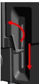
9. Ziehen Sie den Hebel des Festanschlags in dieser Stellung handfest an. Der Festanschlag begrenzt nun die Bohrtiefe für die nächsten Bohrungen.
