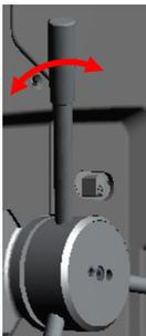
11. Führen Sie das Bohrkreuz anschließend wieder nach oben zurück in seine Ausgangsposition. Sobald der Gewindebohrer aus dem Werkstück austritt (Bohrtiefenanzeige -0,3 mm) wechselt die Drehrichtung der Spindel wieder in einen Rechtslauf.
