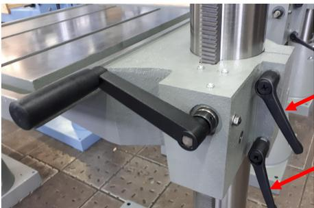
3. Ziehen Sie den/die Spannhebel wieder handfest an, um den Bohrtisch in der eingestellten Höhe zu fixieren.
