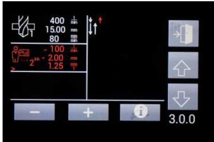
6. Nach Fertigstellung des Programms kann direkt aus der Ansicht 3.0.0 die Maschine gestartet werden und/oder das Programm abgespeichert werden (Kap. 6.5.5).
