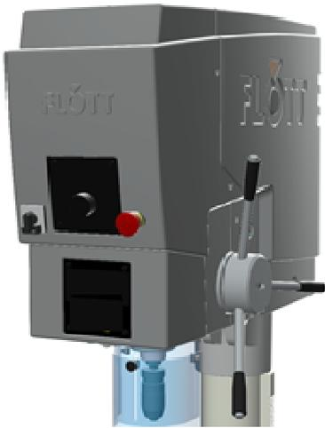
1. Setzen Sie die Schutzhaube leicht nach vorne gekippt von oben auf den Maschinenkopf.
