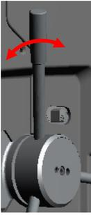
Führen Sie den Bohrer mit Hilfe des Bohrkreuzes nun langsam in Richtung Werkstück, in dem Sie das Bohrkreuz nach unten drücken. Bohren Sie das Durchgangs- oder Sackloch in das Werkstück. Sobald die voreingestellte Bohrtiefe erreicht ist, ertönt ein Signal. Zusätzlich wird Ihnen die Bohrtiefe im Display angezeigt.
