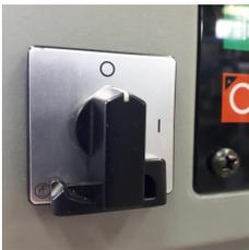
2. Drehen Sie den Hauptschalter Ein/Aus auf die Stellung **0**, um die Maschine komplett auszuschalten.
